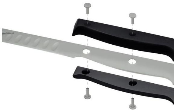
Estos cuchillos están fabricados con la espiga hasta el final del mango y la cacha unida con tres remaches.
